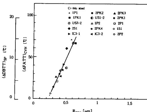
그림 8. 최대표면거칠기  $R_{max}$ 와 재질열화도( $\Delta FATT)_{CVN}$  사이의 관계(피크린산, 25°C, 30분)
