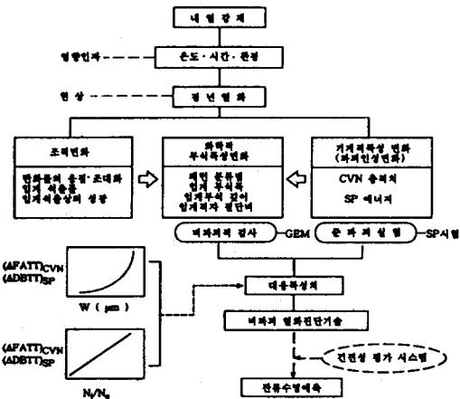
그림 12. SP와 GEM에 의한 재료열화진단기술의 개발 process
