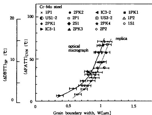
그림 7. 표준 피크린산 포화수용액에 의한 입계폭과  $(\Delta FATT)_{CVN}$  및  $(\Delta DBTT)_{SP}$ 의 상관관계
