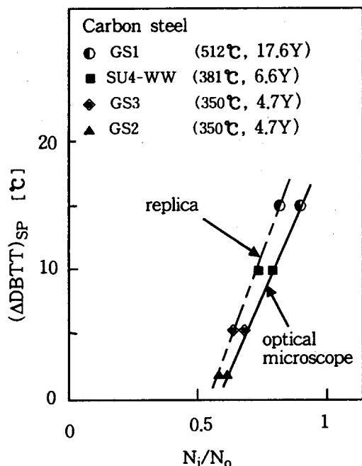
그림 11. 탄소강에 대한 격자절단비( $N_i/N_o$ )와  $(\Delta DBTT)_{SP}$ 의 상관관계
