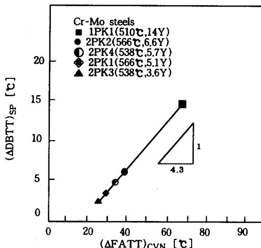
그림 4.  $(\Delta DBTT)_{SP}$ 와  $(\Delta FATT)_{CVN}$  사이의 상호관계
