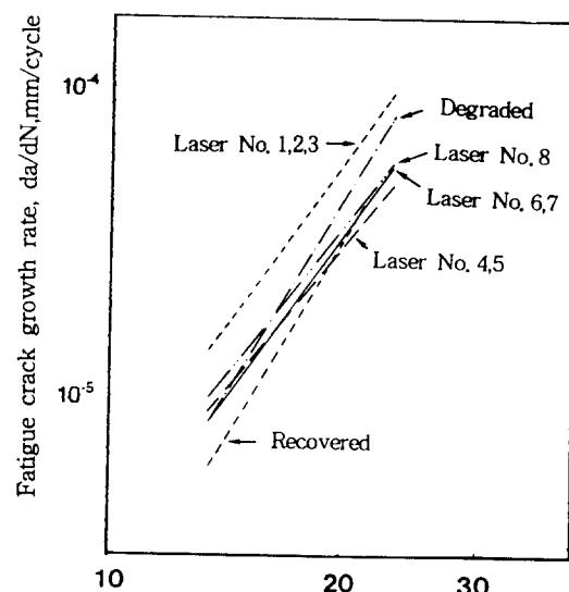
그림 13. 열화재와 레이저빔조사재의  $\Delta K$ -da/dN관계
