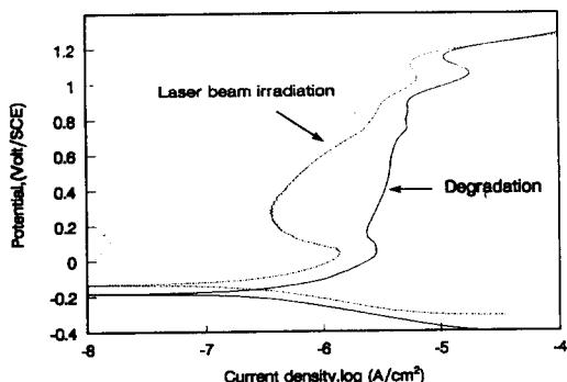
그림 14. 열화재와 레이저 빔 조사재의 전기화학적 분극시험 결과
