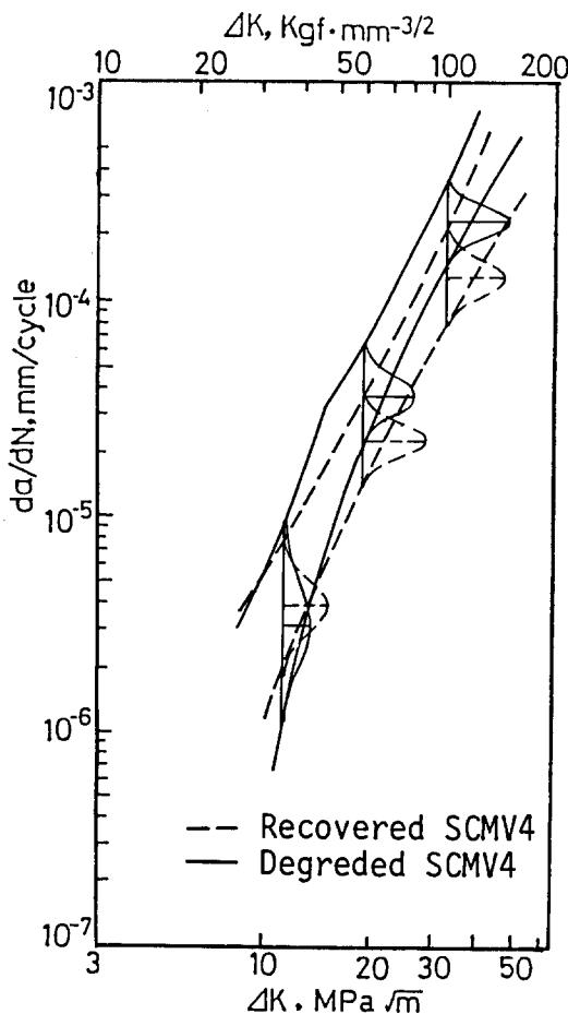
그림 7. 2<sup>1/4</sup>/Cr-1Mo강 열화재와 회복재의  $\Delta K$ -da/dN 관계
