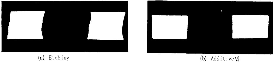
그림 2. Stencil Opening 벽면의 단면 모양
