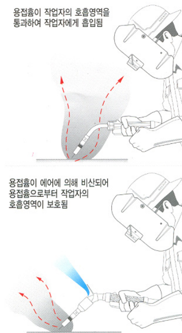
Fig. 3 용접 시 발생된 용접 흡이 토치 헤드로부터 배출되는 압축공기 막에 의해 분리되는 원리에 대한 개략도
